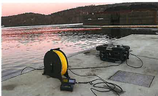
Undervannsdrone (ROV) brukt for kartlegging av utslipp Skjerkøya. Foto: IUA Telemark
